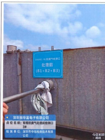
DA001 有组织废气处理前检测口 3# (B1、B2、B3)
